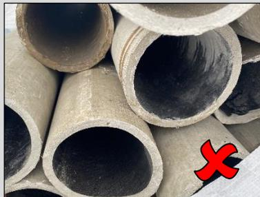
*Platten-BigBags sind zur Verpackung von Rohren nur bedingt geeignet. Die Rohre sind nicht zu einem stabilen Paket verzurrt, sondern liegen lose im BigBag und werden nur über die Schlaufen des BigBags zusammengehalten. Die Anlieferung auf Paletten ist nicht zulässig.*
