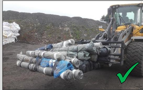
*Die Rohre sind einzeln verpackt und zu stabilen Paketen aus mehreren Einzelrohren gebündelt.*
